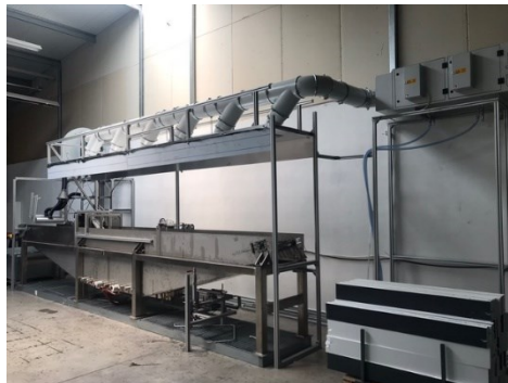
Durchlaufanlage zum Trennen von Aluminium und EPS
